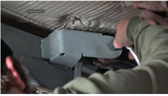
Reinstall upper sway bar end link bolt.
